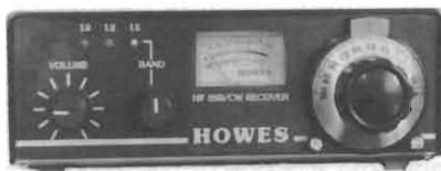
**DXR10** - Ricevitore a tre bande (10, 12, 15 mt) per SSB/CW. Molto compatto e facile da montare, è provvisto di filtro passabanda in ingresso, doppio mixer bilanciato e VFO a FET. L'alimentazione è a 12 volt.
