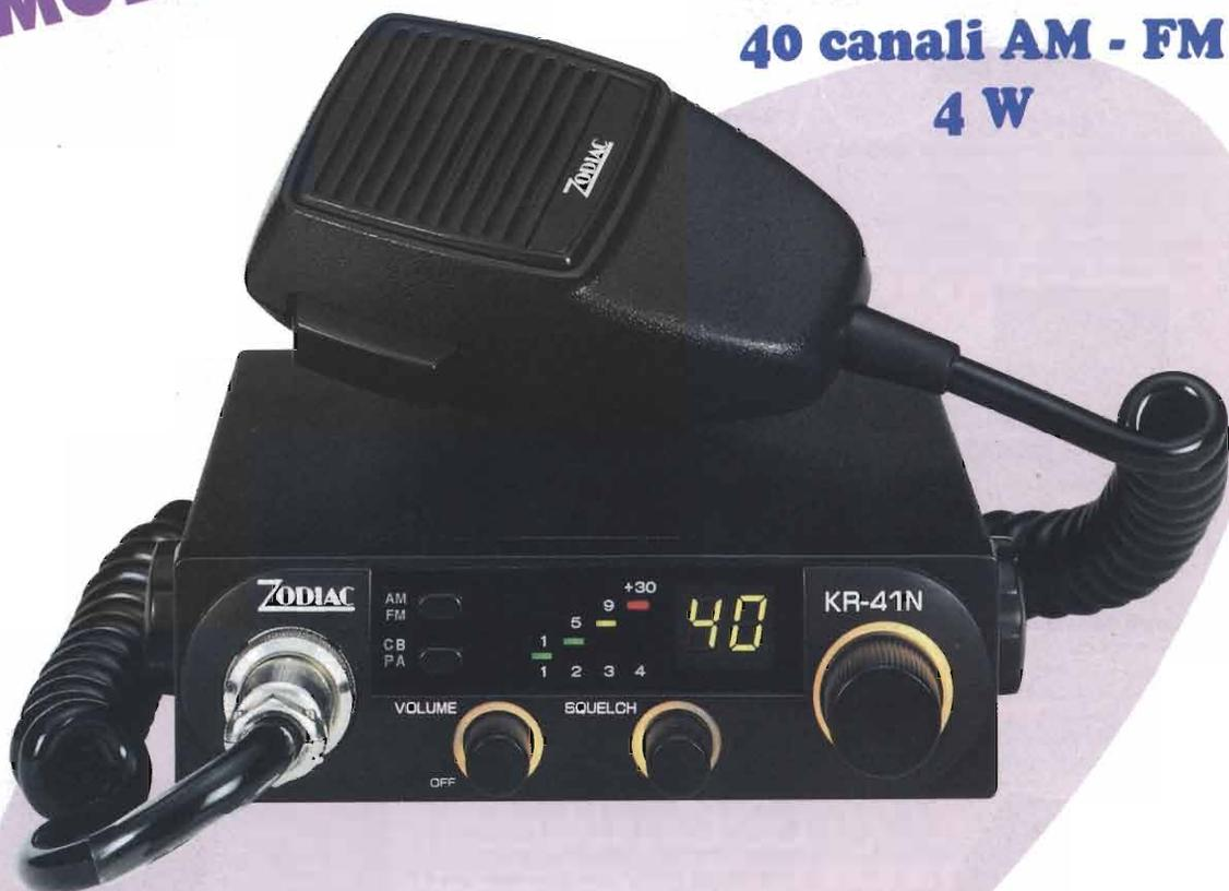
**Nuovo apparato di ridottissime dimensioni. Funzionante in AM/FM, ha la possibilità di operare su 40 canali. Uno strumento digitale a LED indica il segnale RF POWER e il segnale in ricezione. Per facilitarne l'uso nelle ore serali o notturne, le manopole dei principali comandi sono retro illuminate. Il circuito di squelch è regolabile per fornire vari gradi di sensibilità ai segnali d'ingresso.**
